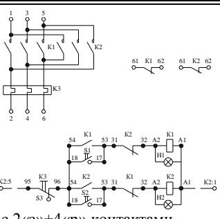
Условные обозначения: K1 – контактор «Вперед», K2 – контактор «Назад», K3 – реле электротепловое, S1 – кнопка «Пуск 1», S2 – кнопка «Пуск 2», S3 – кнопка «Стоп», H1, H2 – сигнальные лампы, пунктирные перемычки устанавливаются потребителем
