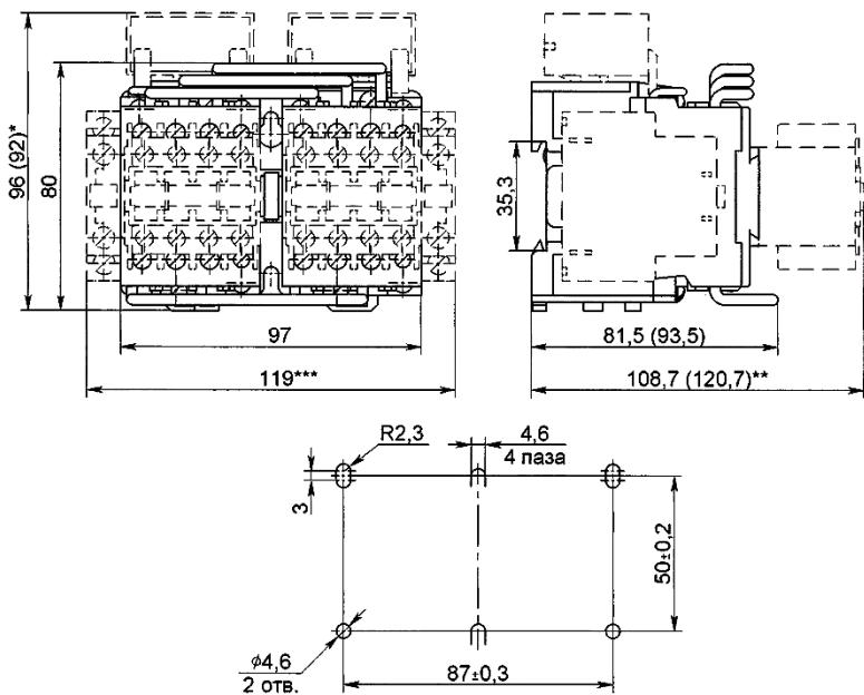
\*Размеры для контакторов с установленными ограничителями перенапряжений ОПНК
