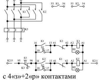
**Условные обозначения:** K1 – контактор «Вперед», K2 – контактор «Назад», K3 – реле электротепловое, S1 – кнопка «Пуск 1», S2 – кнопка «Пуск 2», S3 – кнопка «Стоп», H1, H2 – сигнальные лампы, пунктирные перемычки устанавливаются потребителем
