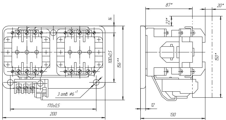
1. \* Размеры определяют границы возможного выброса дуги.
