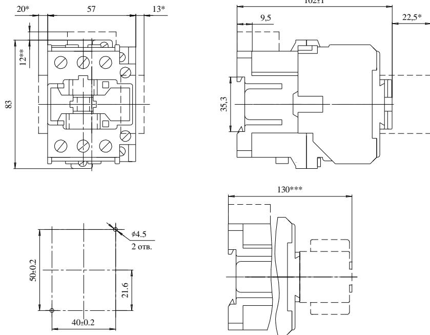
\* Размеры только для пускателей с ограничителями перенапряжений типа ОПН-1, ОПН-2 (вариант К).
