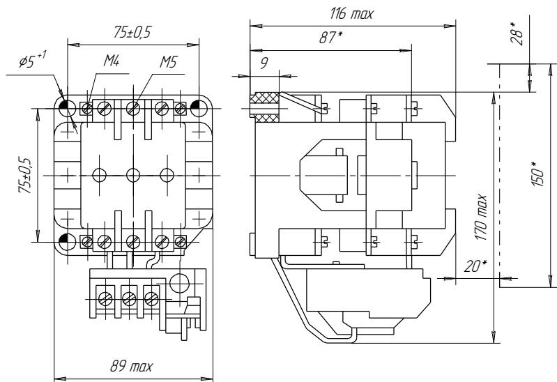
1. \* Размеры определяют границы возможного выброса дуги.
