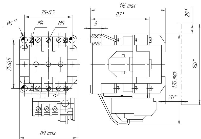
1. \*Размеры, определяющие границы возможного выброса дуги.
