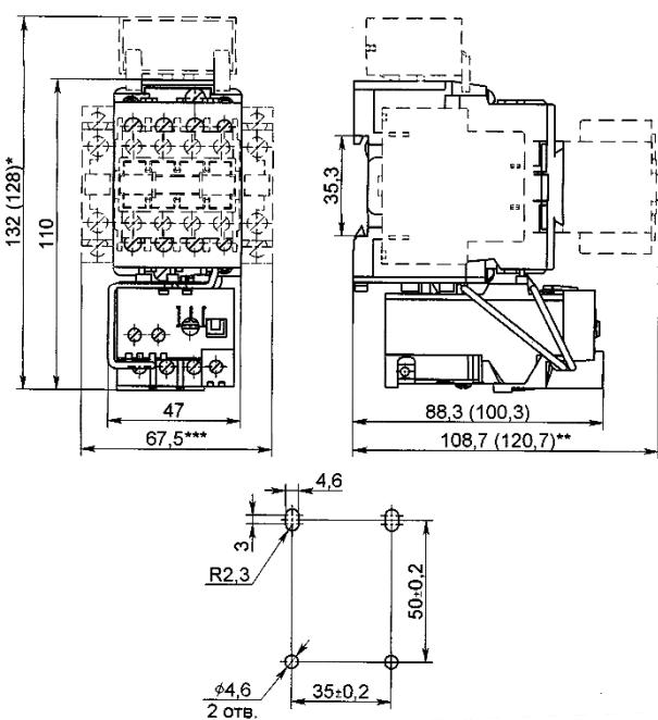
\*Размеры для пускателей с установленными ограничителями перенапряжений ОПНК
