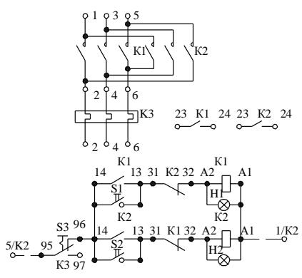
Условные обозначения: К1 – контактор «Вперед», К2 – контактор «Назад», К3 – реле электротепловое (для примера показано с переключающим контактом), S1 – кнопка «Пуск 1», S2 – кнопка «Пуск 2», S3 – кнопка «Стоп», H1, H2 – сигнальные лампы, пунктирные перемычки устанавливаются потребителем
