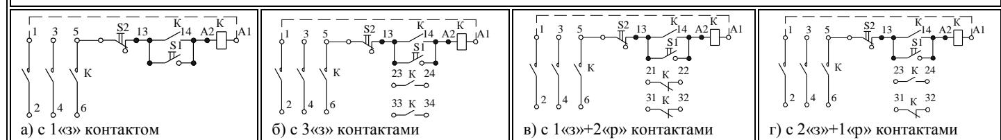
Пускатели нереверсивные, со встроенным в оболочку кнопками управление, степеней защиты IP40 и IP54
