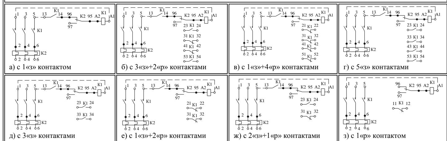
Контакторы нереверсивные, со встроенным в оболочку кнопкам управление, степеней защиты IP40, IP54
