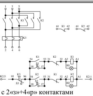
**Условные обозначения:** K1 – контактор «Вперед», K2 – контактор «Назад», K3 – реле электротепловое, S1 – кнопка «Пуск 1», S2 – кнопка «Пуск 2», S3 – кнопка «Стоп», H1, H2 – сигнальные лампы, пунктирные перемычки устанавливаются потребителем
