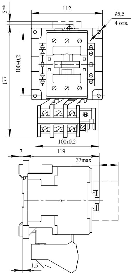
\* Размер только для пускателей с ограничителями перенапряжений типа ОПН-1, ОПН-2 (вариант К).
