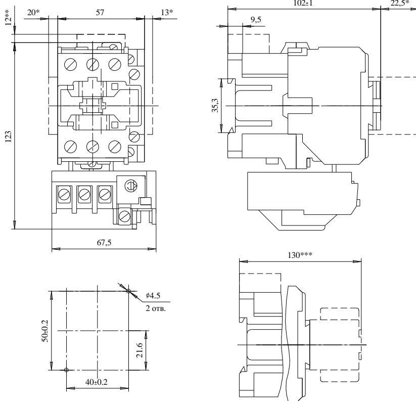
\* Размеры только для пускателей с ограничителями перенапряжений типа ОПН-1, ОПН-2 (вариант К).
