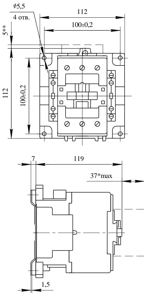
\* Размер только для контакторов с ограничителями перенапряжений типа ОПН-1, ОПН-2 (вариант К).
