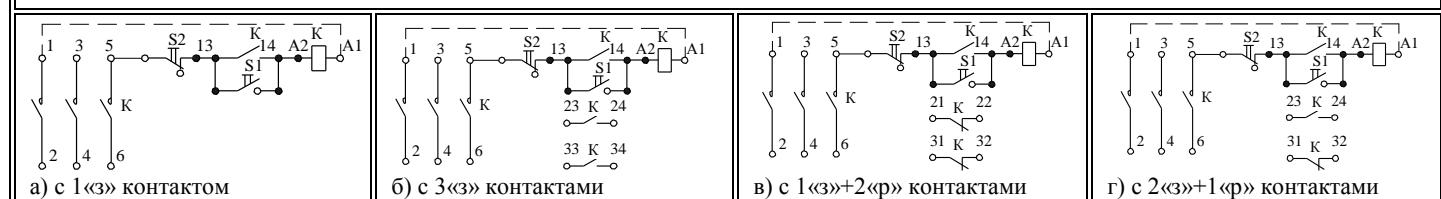
Пускатели нереверсивные, со встроенным в оболочку кнопками управление, степеней защиты IP40 и IP54
