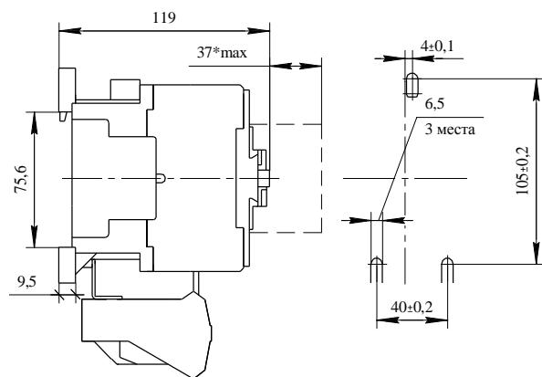
\* Размер только для пускателей с ограничителями перенапряжений типа ОПН-1, ОПН-2 (вариант К).
