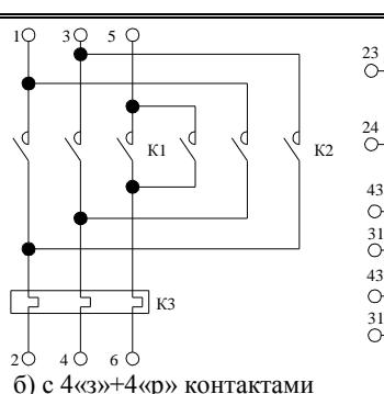
Условные обозначения: К1 – контактор «вперед», К2 – контактор «назад», К3 – реле электротепловое
