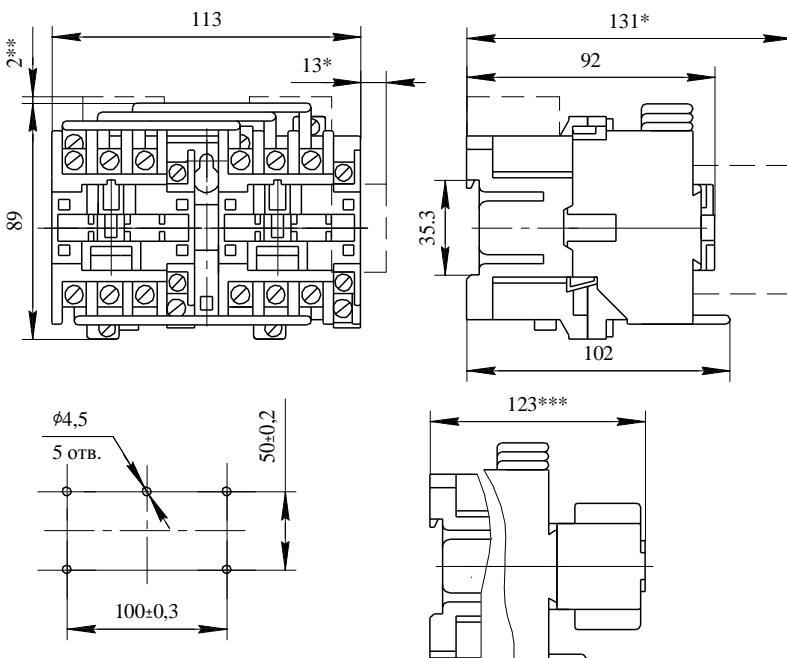
\*Размеры только для контакторов с ограничителями перенапряжений типа ОПН-1, ОПН-2 (вариант К).
