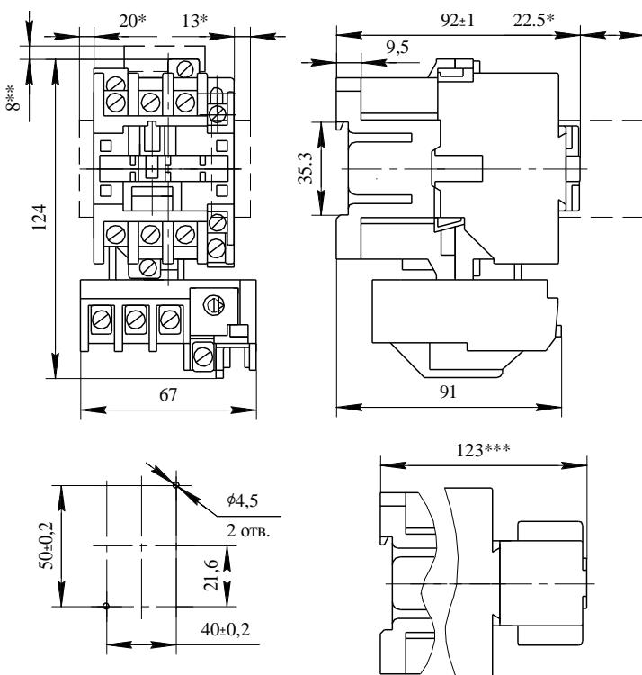
\*Размеры только для пускателей с ограничителями перенапряжений типа ОПН-1, ОПН-2 (вариант К).
