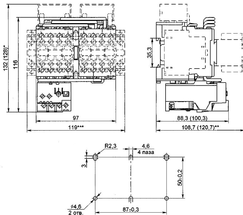
\*Размеры для пускателей с установленными ограничителями перенапряжений ОПНК
