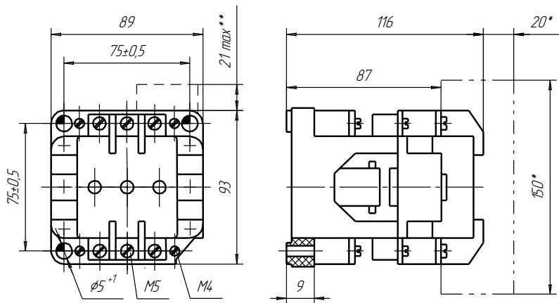
1. \* Размеры определяют границы возможного выброса дуги.
