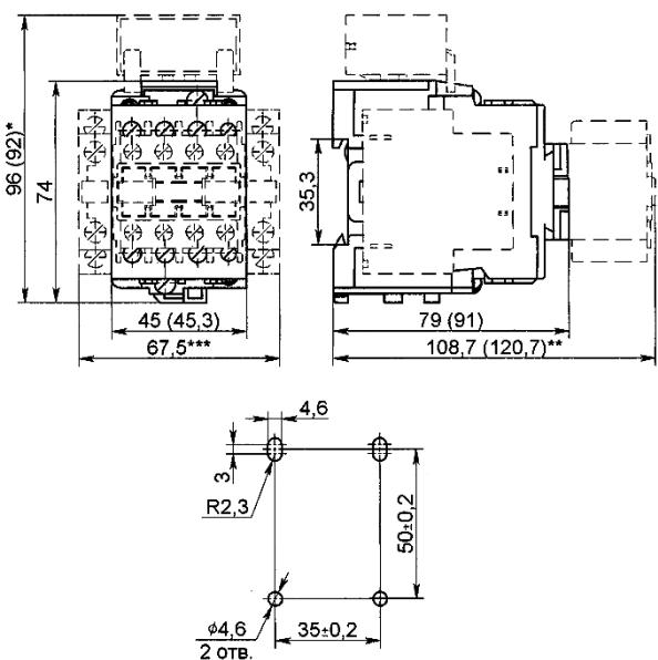
\*Размеры для контакторов с установленными ограничителями перенапряжений ОПНК
