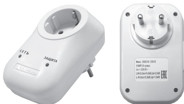
**220 В, 16 А.** Устройство защиты от импульсных перенапряжений, УЗИП Класс III. Время срабатывания менее 25 нс. В корпусе проходной розетки. Защита от импульсных перенапряжений, защита от всплесков напряжения, вызванных ударами молнии. Автоматическое восстановление после перегрузки, замена предохранителя не требуется. Индикация наличия сети, индикация защиты. Защита от детей.
