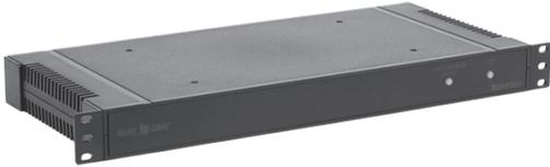
Термокомпенсатор заряда АКБ. Обеспечивает коррекцию напряжения заряда АКБ в зависимости от окружающей температуры, что способствует правильной работе и продлению срока службы АКБ до 2-х раз. Предназначен для работы совместно со стоечными ИБП в составе 19' стойки. Корректно работает с любыми видами свинцово-кислотных АКБ. Напряжение АКБ 36 В (3 шт. 12-вольтовых АКБ) с током заряда до 15 А и током разряда до 30 А. Корпус RACK, высота 1U.
