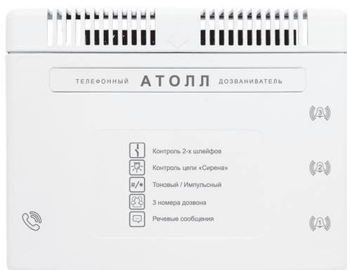
Телефонный дозвониватель по телефонной линии, 2 независимых сигнальных входа, вход типа «Сирена». Энергонезависимая память. Дозвон по 3 номерам, набор номера в импульсном или тоновом режиме, длина номера 15 знаков, включая паузу и «8». Перезапись речевых сообщений для каждой сигнальной цепи, встроенный динамик. Питание 12 В.
