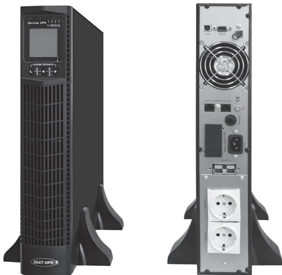
220 В, 3000 ВА (2700 Вт) On-Line, синусоидальная форма выходного напряжения, световая и звуковая индикация режимов работы, ЖК дисплей. Встроенные АКБ 9 Ач, 6 шт, время резерва 3 мин. Возможность подключения внешних АКБ. Дистанционный мониторинг по RS 232, USB, порт для платы релейного интерфейса. Возможность подключения SNMP-модуля DL 801. Функция удаленного аварийного отключения выходного напряжения (EPO). Корпус под 19» шкафа, высота 2U или настольная установка.
