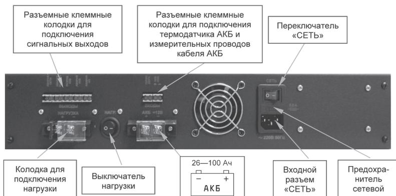
**12 В, 18 А, регулируемый ток заряда АКБ, термокомпенсация тока заряда АКБ. Корпус для установки в 19" шкаф, высота 2U, 5 информационных выходов о состоянии источника в формате «сухие контакты реле». Электронная защита от перегрева, КЗ выхода и АКБ. Кнопка отключения нагрузки. Диапазон входного напряжения 170–250 В**
