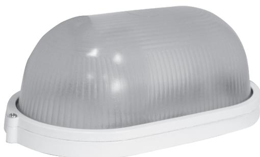
Светильник в герметичном корпусе IP54 со встроенной бесперебойной светодиодной лампой. Емкость литий-ионного аккумулятора 900 мАч. Работает как аварийный светильник при отсутствии электроэнергии сети. Стандартный цоколь E27.
