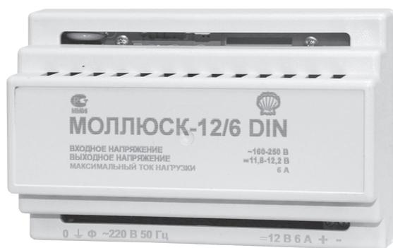
12 В, 6 А. Расширенный сетевой диапазон 160–250 В. Малогабаритный корпус 139 x 89 x 65 мм, монтаж на DIN рейку 35 мм, защита выхода от КЗ и перегрузки, прочность изоляции 3 кВ.
