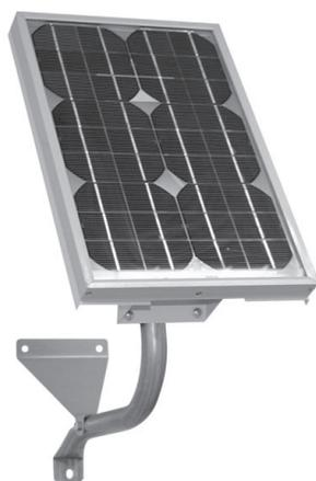
Фотоэлектрический модуль для преобразования солнечной энергии в электрическую с последующей ее передачей в источник питания. Мощность до 15 Вт. Уличное исполнение. Класс защиты IP56, рабочий температурный диапазон от -40 °С до +50 °С. В комплекте поворотный кронштейн для задания необходимого положения в вертикальной и горизонтальной плоскости.
