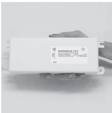
12 В, 7 А, габариты 205 x 70 x 40 мм, защита выхода от КЗ и перегрузки, прочность изоляции 3 кВ, проушины для крепления, корпус IP67.
