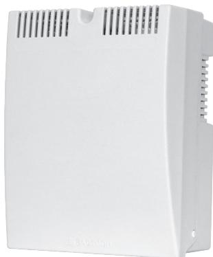
12 В, 3 А, пластиковый корпус под АКБ 7 Ач, защита АКБ, защита выхода от КЗ и перегрузки.
