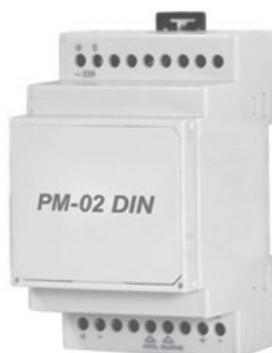
2-х каналный релейный модуль для управления нагрузкой 220 В, 8 А. Управляющий сигнал 12 В. Предназначен для использования в системах дежурного освещения, пожарной и охранной сигнализации, а также иных коммутируемых системах с управлением нагрузкой по двум каналам. Входит в состав интеллектуальной системы освещения. Крепление на DIN рейку.
