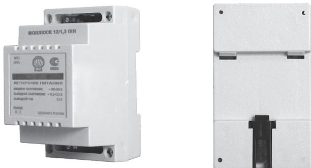
Источник питания 12 В, 1,3 А. Расширенный сетевой диапазон 100–250 В. Корпус на DIN рейку, защита выхода от КЗ и перегрузки, прочность изоляции – 3 кВ.
