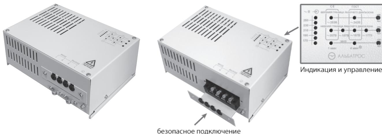
Устройство защиты всего дома/квартиры 220 В, 12 кВт от кратковременных и длительных перенапряжений до 500 В, вызванных наводками в результате воздействия электромагнитных импульсов (грозовые разряды, коммутационные помехи и др.) и авариями в сети.
