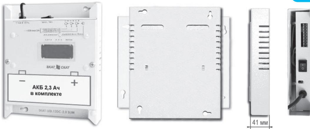
Источник бесперебойного питания с функцией управления светодиодными светильниками. 3 выхода 12 В до 2 А. Управляющий вход. Режимы работы «Аварийный», «Дежурный» и «Дежурный управляемый». Питание внешних датчиков. АКБ 2,3 Ач в комплекте. Индикация состояния источника и АКБ. Настенная/настольная/потолочная установка, ультратонкий корпус (42 мм). Габариты 220 x 182 x 42 мм.
