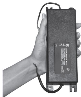
Источник питания предназначен для питания радиоэлектронных устройств широкого применения напряжением 12 В постоянного тока от сети переменного тока напряжением 220 В, защищен от перегрузки и короткого замыкания на выходе, работоспособен на холостом ходу.
