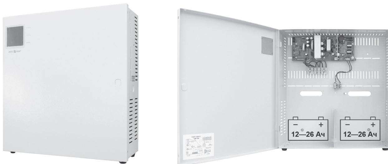
**12 В, 11 А. Корпус под 2 АКБ 26 Ач, диапазон входного напряжения 170–250 В. Сообщение «Переход на резерв» (осуществляется с регулируемой задержкой). Соответствует ФЗ 123 и ГОСТ Р 53325-2012: 3 индикатора и 3 информационных выхода – Сеть, АКБ, Выход, защита выхода от перегрузки и КЗ, защита АКБ от глубокого разряда, КЗ и переплюсовки, контроль наличия АКБ, холодный пуск.**
