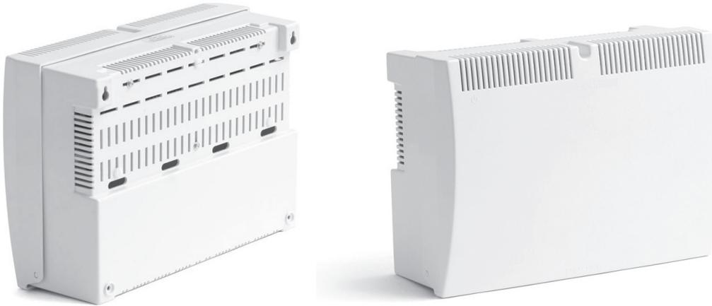
Источник бесперебойного питания для POE коммутаторов. Питание коммутаторов, инжекторов и другой (PoE) нагрузки стабилизированным напряжением 48 В мощностью до 120 ВА. Электронная защита нагрузки от токовой перегрузки и короткого замыкания. Электронная защита от аварийного повышения напряжения на выходе. Защита АКБ от глубокого разряда и короткого замыкания. Пластиковый корпус под 2 АКБ 7–12 Ач.
