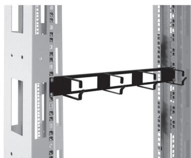
Горизонтальный органайзер 19» 1U, 4 кольца, с окнами для кабеля, черный металлический. Предназначен для удобного размещения коммутационного кабеля. Выполнен из цельнометаллической панели высотой 1U, с четырьмя приваренными кольцами, имеет три дополнительных окна для прокладки кабеля, удобен для организации коммутационного кабеля при плотном размещении оборудования. Органайзер имеет порошково-полимерное покрытие серого или черного цвета.
