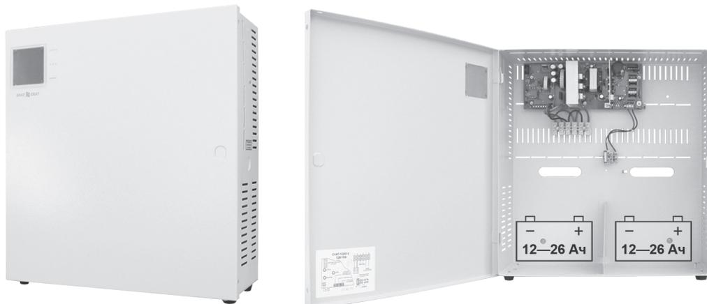
**24 В**, максимальный ток нагрузки при наличии АКБ – 20 А, суммарный ток нагрузки и заряда АКБ в длительном режиме при наличии сети до 3,5 А. Корпус под АКБ 26 Ач (2 шт.).
