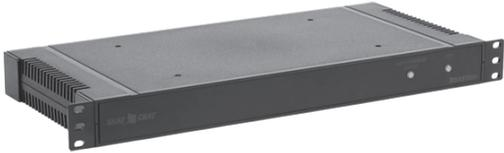
Термокомпенсатор заряда АКБ. Обеспечивает коррекцию напряжения заряда АКБ в зависимости от окружающей температуры, что способствует правильной работе и продлению срока службы АКБ до 2-х раз. Предназначен для работы совместно со стоечными ИБП в составе 19' стойки. Корректно работает с любыми видами свинцово-кислотных АКБ. Напряжение АКБ 48 В (4 шт. 12-вольтовых АКБ) с током заряда до 15 А и током разряда до 50 А. Корпус RACK, высота 1U.
