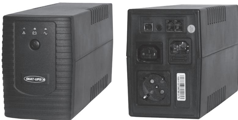
**220 В, 800 ВА (480 Вт)**, встроенный АКБ 9 Ач, время резерва 7 мин., холодный старт, модифицированный синус, световая и звуковая индикация режимов работы, связь и управление с ПК по USB. Встроенный стабилизатор (диапазон сети 160–290 В), защита от всплесков напряжения, защита от перегрузки. Стандартная и компьютерная розетки.
