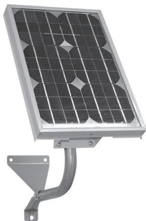
Фотоэлектрический модуль для преобразования солнечной энергии в электрическую с последующей ее передачей в источник питания. Мощность до 30 Вт. Уличное исполнение. Класс защиты IP56, рабочий температурный диапазон от -40 °С до +50 °С. В комплекте поворотный кронштейн для задания необходимого положения в вертикальной и горизонтальной плоскости.
