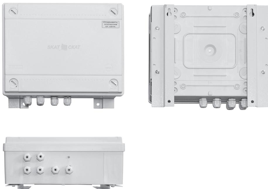
Сетевой (не бесперебойный) источник питания. Выходное переменное напряжение **24 В** или **27 В**, **50 Гц**. **5** выходов, ток каждого выхода **1 А**. Выход **27 В** используется для компенсации падения напряжения на длинной линии. Защита выходов от КЗ PolySwitch, световая индикация по каждому каналу. Возможность объединения каналов до **5 А**. Уличное исполнение, класс защиты **IP56**. Рабочий температурный диапазон от **-40 °С** до **+50 °С**.
