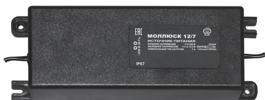
12 В, 10 А, габариты 205 x 70 x 40 мм, защита выхода от КЗ и перегрузки, прочность изоляции 3 кВ, проушины для крепления, корпус IP67.
