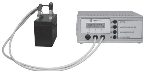
Полностью автоматическое устройство тестирования, тренировки, восстановления и заряда свинцово-кислотных АКБ – герметичных и открытого типа (автомобильные). Заряд АКБ с током заряда 1/20 от остаточной емкости. Ускоренный заряд АКБ с током заряда 1/6 от остаточной емкости. Восстановление АКБ, имеющих сульфатацию пластин. Тренировка АКБ с помощью циклов разряда/заряда. Цифровой дисплей. Работает с АКБ до 120 Ач.
