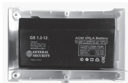
Отсек под АКБ 1,2 Ач – 1 шт. Крепление на ДИН рейку 35 мм.
