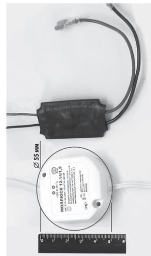
Компактный источник бесперебойного питания 12 В, 1,3 А. Расширенный сетевой диапазон 90–250 В, защита выхода от КЗ и перегрузки, прочность изоляции 3 кВ, ток заряда АКБ до 0,35 А. Светодиодная индикация. Плата контроля заряда АКБ в комплекте для использования в качестве ИБП.
