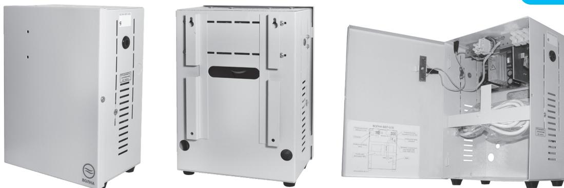
ИБП для стационарных радиостанций 13,8 В, ток до 30 А, при соотношении передача/прием 1:2, корпус под АКБ 26 Ач. Выходной ток 30 А в режиме передачи, используя энергию АКБ. Заряд АКБ током 5 А. Возможность работы как со встроенной АКБ (26 Ач), так и с внешней (до 200 Ач). Автоматическая подзарядка и защита аккумулятора от глубокого разряда. Защита от перегрева с автоматическим переходом в резервный режим. Защита от переплюсовки аккумулятора.
