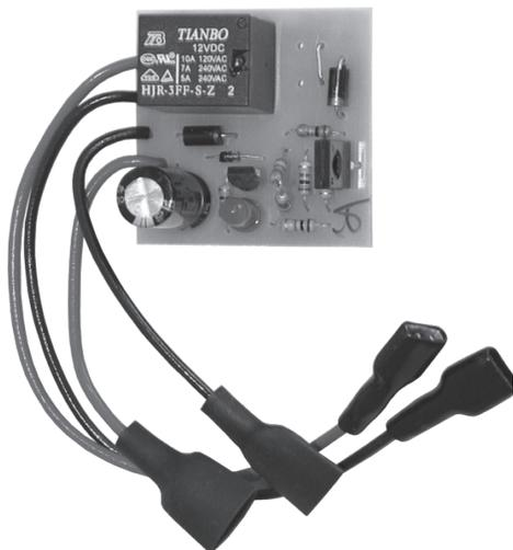
Блок БКА-12 предназначен для защиты аккумуляторной батареи (АКБ) от глубокого разряда и рассчитан на совместную работу с устройствами, использующими свинцово-кислотные АКБ номинальным напряжением 12 В. БКА-12 отключает нагрузку от АКБ при падении напряжения на клеммах АКБ до уровня 10–10,5 В. БКА-12 подключается между клеммами АКБ и аккумуляторными клеммами устройства. БКА-12 обеспечивает индикацию светодио-дом факта подключения АКБ к нагрузке.
