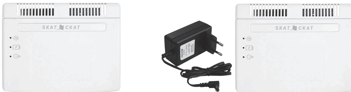
Малогабаритный ИБП со встроенной Li-ion АКБ. Внешний блок питания. Стабилизированное выходное напряжение 12 В, Выходной ток 1 А. Время работы от АКБ на максимальной нагрузке 2 часа. Защита АКБ от разряда. Защита АКБ от КЗ в нагрузке. Электронная защита выхода от КЗ. Выключатель АКБ. Переходник 5,5х2,5 в комплекте. Холодный пуск. Собственное потребление менее 40 мА. Внутренняя Li-ion АКБ 5200 мАч, 7,4 В (в комплекте). Корпус под DIN рейку 35 мм, Размер – 150 х 120 х 45 мм. Гарантия 5 лет.
