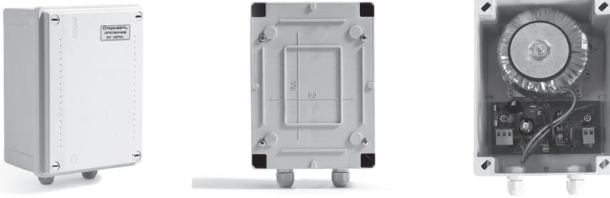
Трансформаторный (не бесперебойный) источник питания. Выходное переменное напряжение 24 В, 50 Гц. Номинальный ток выхода 2 А. Защита выходов от КЗ посредством самовосстанавливающегося предохранителя. Световая индикация короткого замыкания и наличия напряжения сети. Защита выхода от импульсов перенапряжения амплитудой до 10 кВ. Уличное исполнение, класс защиты IP 56. рабочий температурный диапазон от - 40 °С до + 50 °С
