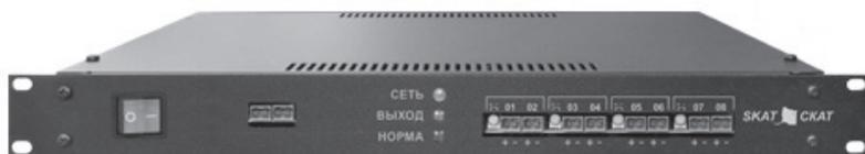
19", 1U, 8 выходов по 0,5 А или 4 выхода по 1 А. Плавная регулировка выходного напряжения, максимальный ток по всем выходам – 4,5 А, 2 внешние АКБ 26 Ач. 2 информационных выхода о состоянии источника.
