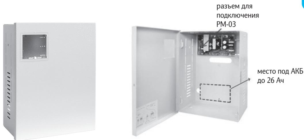
**12 В, 5 А. Работа с 2-мя независимыми АКБ, 2 канала зарядки. Корпус под 2 АКБ 17 Ач, диапазон входного напряжения 150–250 В. Соответствует ФЭ 123 и ГОСТ Р 53325-2012:**
