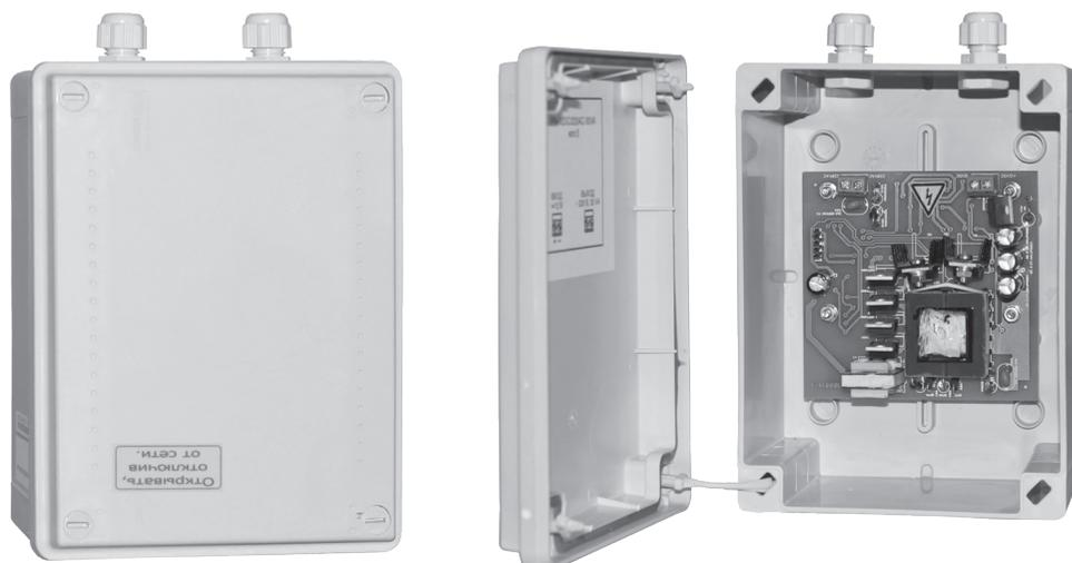
Преобразователь напряжения с входного 12–15 В в выходное 220 В. Мощность 30 ВА. Уличное исполнение. Класс защиты IP56, рабочий температурный диапазон от -40 °С до +50 °С.
