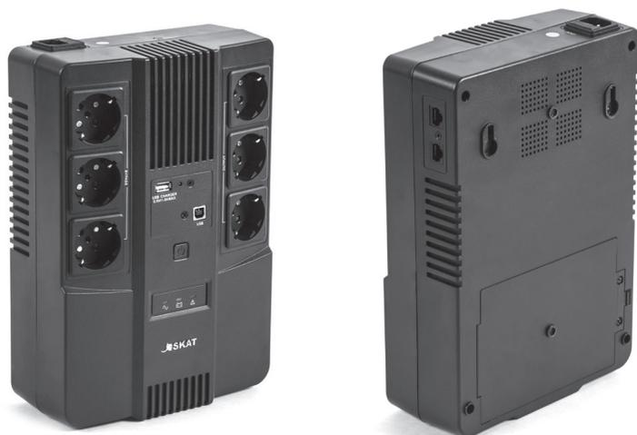
**220 В, 800 ВА (480 Вт)**, встроенный АКБ 9 Ач, время резерва 3 мин., холодный старт, модифицированный синус, световая и звуковая индикация режимов работы, связь и управление ПК по USB. Встроенный стабилизатор (диапазон сети 170–270В), защита от всплесков напряжения, защита от перегрузки. 6 выходных розеток: 3 шт. CEE 7/4 (розетка с заземлением) с питанием от АКБ, 3 шт. CEE 7/4 (розетка с заземлением) без питания от АКБ.
