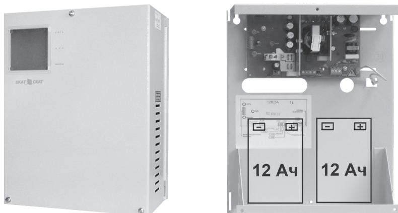
**12 В, 5 А, Работа с 2-мя независимыми АКБ, 2 канала зарядки. Корпус под 2 АКБ 12 Ач или 1 АКБ 17 Ач, диапазон входного напряжения 150–250 В. Соответствует ФЗ 123 и ГОСТ Р 53325-2012:**
