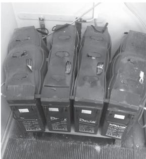
Последствия эксплуатации АКБ при повышенной температуре без термокомпенсации заряда
