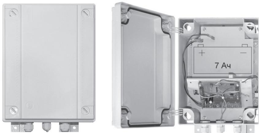
12 В, 5 А. Источник питания для подключения к солнечной батарее. Уличное исполнение, класс защиты IP56, место для установки АКБ 7 Ач. Управление выходом от внешнего датчика движения или кнопки с регулируемой задержкой выключения. Режим работы день/ночь.
