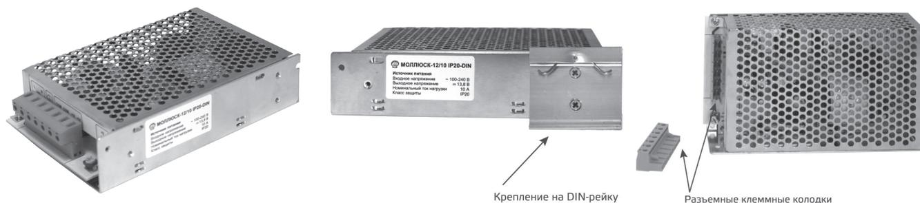
12 В, 10 А. Расширенный сетевой диапазон 100–240 В, габариты 160х99х37 мм. Перфорированный корпус IP20. Дополнительное крепление на DIN-рейку, защита выхода от КЗ и перегрузки. Быстроразъемные клеммы. Регулировка выходного напряжения.
