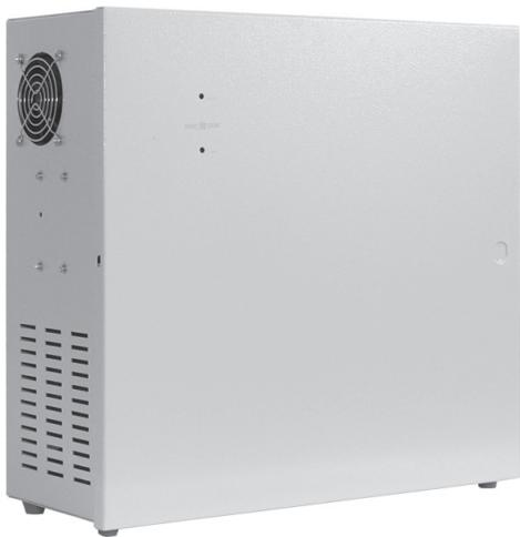
32 выхода по 0,5 А или 16 выходов по 1 А. Регулировка выходного напряжения, регулируемый ток заряда АКБ, максимальный ток по всем выходам – 14 А, корпус под 2 АКБ 40 Ач, 5 информационных выходов о состоянии источника. Независимая регулировка выходного напряжения по каналам, фильтрация помех по каждому каналу, защита от КЗ и перегрузки по каждому каналу.
