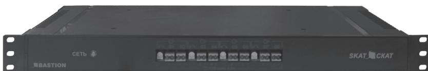
19", 1U, 8 выходов по 0,5 А, 12 В или 4 выхода по 1 А. Плавная регулировка выходного напряжения от 12 до 15 В, максимальный ток по всем выходам 4 А. Электронная защита выходов по току и от КЗ, фильтрация помех для устранения взаимного влияния нагрузок. Не бесперебойный.
