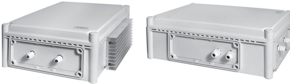
ИБП для стационарных радиостанций 13,8 В, ток до 19 А, при соотношении передача/прием 1:4, пластиковый корпус уличного исполнения (класс защиты IP56) под АКБ 12–17 Ач. При температурах до  $-40^{\circ}\text{C}$  использовать в комплекте с АО 1/40 исп.5 и термостатами 12/7, 12/12, 12/26 или 12/40.
