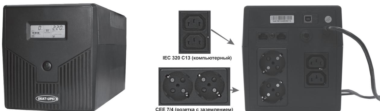
**220 В, 1000 ВА (600 Вт),** встроенные АКБ 9 Ач, 2 шт, холодный старт, модифицированный синус, световая и звуковая индикация режимов работы, графический дисплей режимов работы, связь и управление с ПК по USB. Встроенный стабилизатор (диапазон сети 170–270 В), защита от всплесков напряжения, защита от перегрузки. 4 выходных разъема: 2 компьютерных IEC 320 C13 и 2 шт. – CEE 7/4 (розетка с заземлением).
