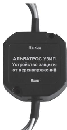
220 В, 5 А. Устройство защиты от импульсных перенапряжений, УЗИП Класс III. Время срабатывания менее 25 нс. Максимальный импульсный разрядный ток (импульс 8/20 мкс), 6,5 кА, уровень напряжения защиты, 1,2 кВ. Уличное исполнение, IP65, рабочий температурный диапазон от -40 °С до +50 °С.
