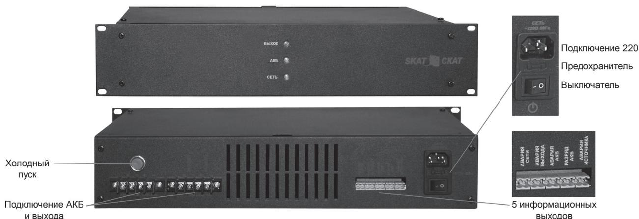
**48 В, 10 А.** Для построения систем питания удаленных объектов совместно с преобразователями напряжения. Ток заряда АКБ – 2, 4, 6 или 10 А, термокомпенсация заряда АКБ, контроль и защита АКБ от глубокого разряда, холодный пуск. Работает от 4-х внешних АКБ до 120 Ач. Защита выходов от перенапряжения, защита АКБ, 5 информационных релейных выходов о состоянии сети, АКБ, источника. Корпус для установки в 19" шкаф, высота 2U.
