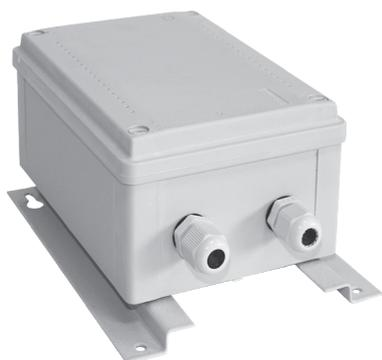
Защитное устройство АЛЬБАТРОС-1500 исп.5 предназначено для защиты потребителей электрической сети 220 В, 50 Гц с потребляемой мощностью до 1,5 кВт от кратковременных и длительных перенапряжений до 500 В переменного тока промышленной частоты 50 Гц. Уличное исполнение, IP56.
