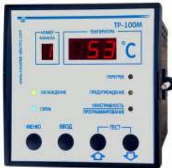
Цифровое температурное реле **TP-100M** является микропроцессорным устройством, предназначенным для измерения и контроля температурного режима сухого трансформатора по четырем датчикам, подключаемым по двух- или трехпроводной схеме, с последующим отображением температуры на дисплее и выдачей сигналов тревоги при выходе каких-либо параметров за установленные пределы. Изделие также может применяться для защиты двигателей и генераторов.
