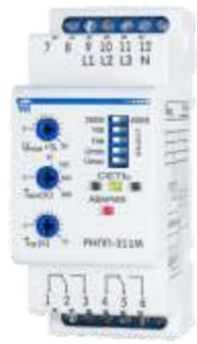
**РНПП-312** Реле напряжения **РНПП-312** предназначено для защиты 3-фазных Потребителей от аварий в электросети путем отключения. При восстановлении параметров сети происходит автоматическое включение. Наличие пяти dip-переключателей позволяет ввести или вывести те или иные функции, выбрать тип сети: реле минимального /максимального напряжения, реле обрыва фаз, реле асимметрии фаз, реле чередования фаз, а также комбинации этих режимов. Размеры 1-S модуль.
