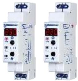
Реле напряжения **РН-118, РН-119** предназначено для отключения бытовой и промышленной однофазной нагрузки при недопустимых колебаниях напряжения в сети с последующим автоматическим включением после восстановления параметров сети.
