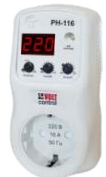
Реле напряжения **РН-116** предназначено для отключения бытовой и промышленной 1- фазной нагрузки 220 В, 50 Гц мощностью до 3,5кВт (до 16 А) при недопустимых колебаниях напряжения в сети с автоматическим повторным включением после восстановления параметров сети.
