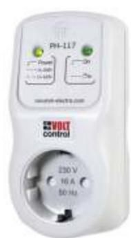
**РН-117** обеспечивает отключение защищаемого оборудования, если значение напряжения сети выходит за пределы 165 - 260 В (после восстановления параметров сети произойдет автоматическое повторное включение (АПВ - 5 сек.) - индицирует соответствие напряжения электрической сети действующим стандартам, состояние аварии и наличие напряжения в розетке изделия..
