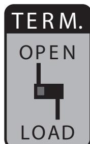
При подключении блока DIB-6000 к шине управления RS-485 необходимо произвести включение или отключение терминального резистора с помощью переключателя TERM.
