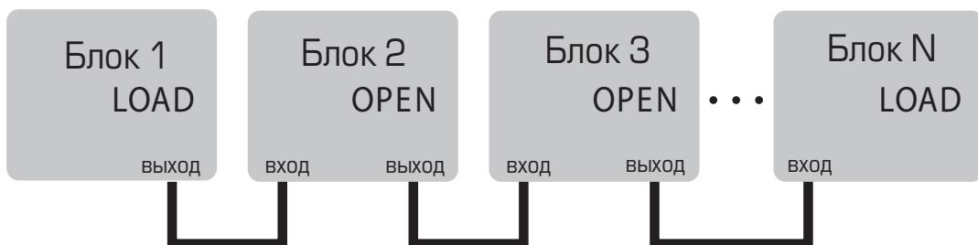
Если DIB-6000 образует или завершает шину управления, как Блок 1 и Блок N на рисунке, то переключатель TERM должен находиться на отметке LOAD.
