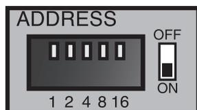
При помощи DIP переключателя на задней панели в двоичном коде следует установить номер блока резервирования в системе в соответствии с таблицей.
