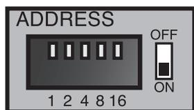
При помощи DIP переключателя на задней панели в двоичном коде следует установить номер блока в системе в соответствии с таблицей.
