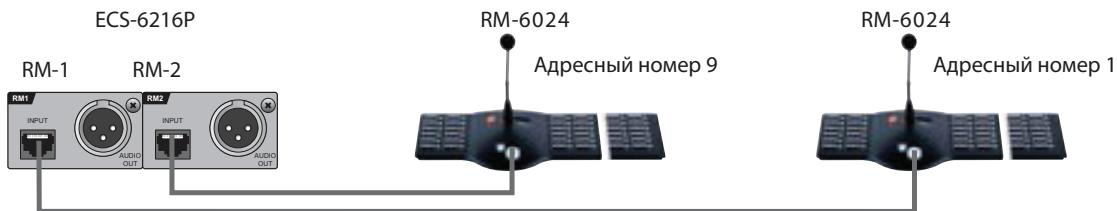
Когда микрофонные панели подключаются к контроллеру RME-6108, то входу RM1 контроллера ECS-6216P соответствует адресный номер в диапазоне 1-8, а входу RM2 контроллера ECS-6216P соответствует адресный номер в диапазоне 9-16.
