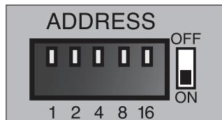
Если адресный номер не установлен, то микрофонная панель оповестит об этом миганием индикаторов активности всех зон. Если адресный номер установлен неправильно, то индикатор Fault на микрофонной панели оповестит об этом.
