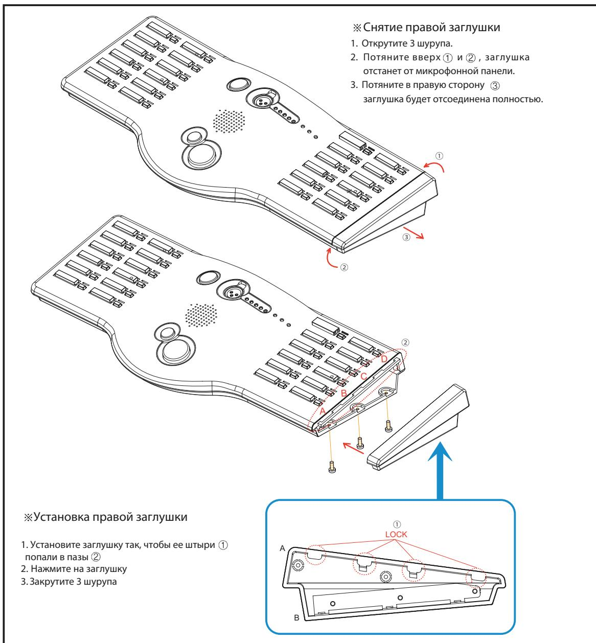
Дополнительная клавиатура RM-6012KP устанавливается по тому же принципу, что и заглушка. Подключение дополнительной клавиатуры производится с помощью разъемов скрытых в корпусе. После установки дополнительной клавиатуры ее также необходимо закрыть заглушкой.
