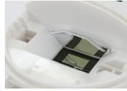
Для этого в извещателях установлен дополнительный активный ИК-модуль, который фиксирует все посторонние предметы вблизи линзы.
