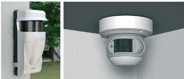
В основе лазерных детекторов RLS лежит призма с полигональными зеркалами, вращающимися с частотой 600 оборотов в минуту. Извещатель формирует невидимый и абсолютно безопасный для человеческого глаза лазерный луч, который, попадая на зеркало, отражается в сканируемую область.
