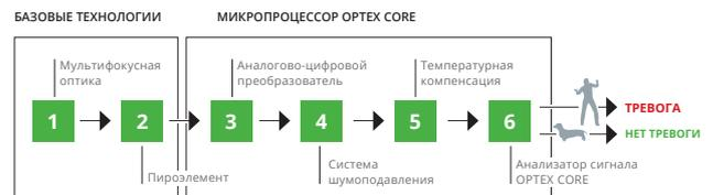
Работа процессора CORE основана на алгоритме логического сравнения формы сигналов от различных источников ИК-излучения. Анализируя полученные данные и сравнивая их с хранящимися в памяти образцами, процессор принимает решение о том, может ли источником этого сигнала быть реальный нарушитель или нет.
