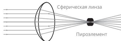
На пироэлемент поступает максимально точный сигнал от каждой зоны детекции с четко обозначенными границами, что обеспечивает высокий уровень контрастности с фоном и точность детекции.
