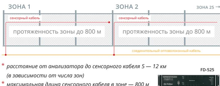
Анализаторы серии FD-525 предназначены для защиты протяженных периметров особо важных промышленных и государственных объектов с большим количеством и высокой плотностью зон.
