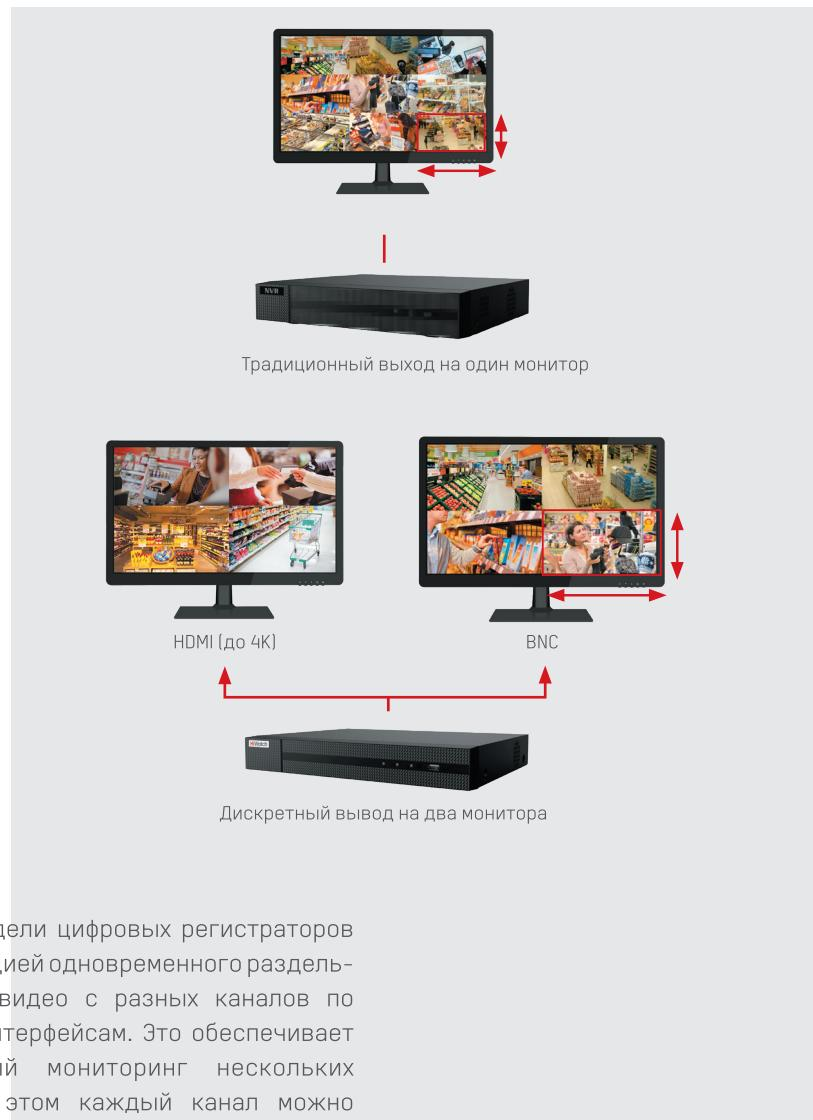
Выбирайте модели цифровых регистраторов HiWatch с функцией одновременного раздельного вывода видео с разных каналов по уникальным интерфейсам. Это обеспечивает одновременный мониторинг нескольких каналов. При этом каждый канал можно разместить в отдельном окне, достаточно большом, чтобы наблюдатели могли видеть все необходимые детали.
