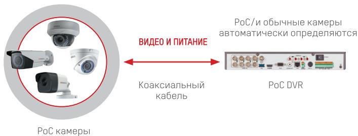
Благодаря технологии PoC подключение аналогового видеонаблюдения становится намного проще и эффективнее, а стоимость ниже.
